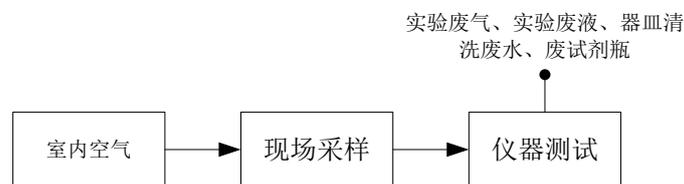
图 2 项目室内空气检测流程图
